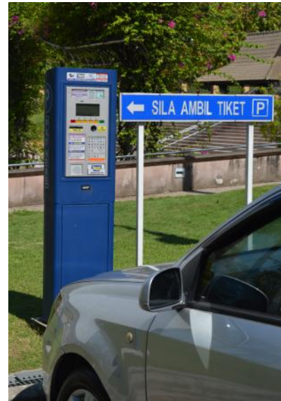
Foto 63 : Contoh meter berpusat menggunakan syiling/kad pintar/ kredit.
