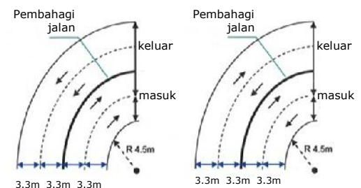
Rajah 28 : Contoh lengkungan bagi landas melebihi satu laluan dengan penyediaan pembahagi jalan
